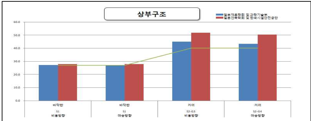
【그림 1.4.3】 상부구조 반발경도시험 측정결과
